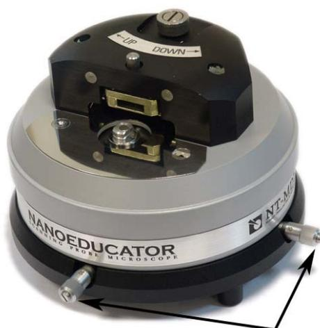
Рис. 2-2. Винты перемещения образца в горизонтальной плоскости
