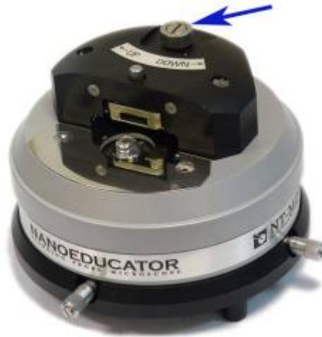
Рис. 2-3. Регулировка положения держателя зондового датчика
