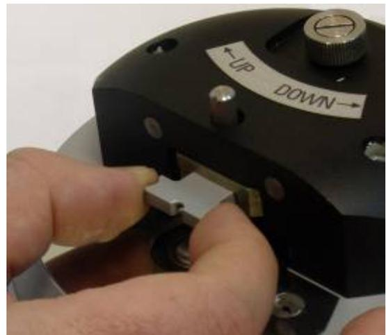
б. Установка зондового датчика
