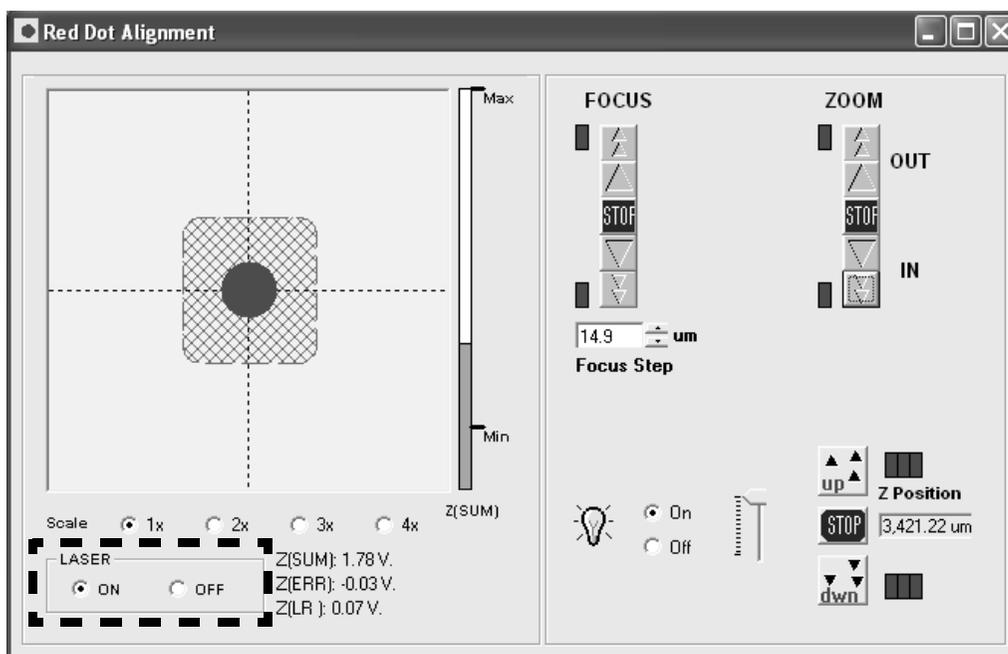
Figure 3.12. Turning off the laser.
